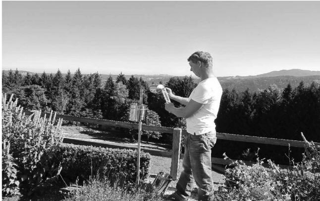
Die zu errichtende Niederschlagsstation wird mit einem vom Deutschen Wetterdienst bereitgestellten Hellmann-Niederschlagsmesser ausgerüstet. Um eine Beeinflussung der Messungen zu vermeiden, wird dieser auf einem geeigneten Grundstück in ausreichendem Abstand zu Gebäuden und Bewuchs aufgestellt. Hindernisse sollten dabei etwa doppelt so weit entfernt sein, wie sie hoch sind.
